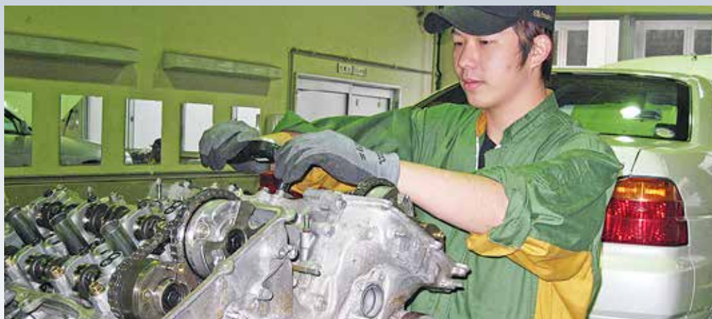
▲エンジン組立実習
