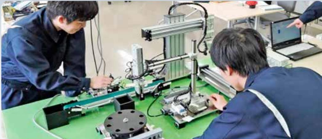
▲製造ラインの制御実習 工場の自動化に向けて、PLCという機器を用いて、製品を自動で運んだり、仕分けしたりするラインの制御をしています。
