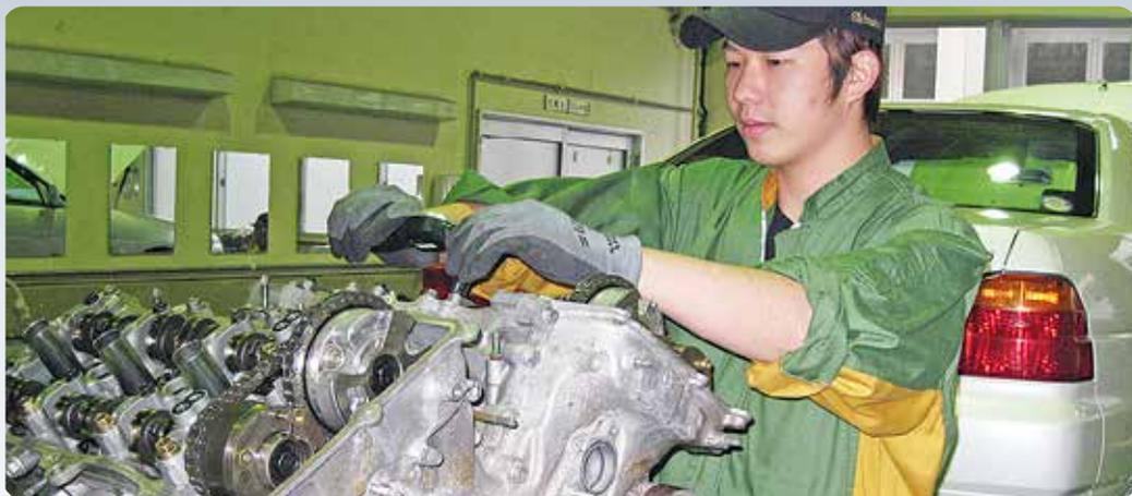
▲エンジン組立実習 エンジンの性能を左右する組立作業において、決められた順序や方法に従い、ボルト・ナットの締め付けを行っています。
