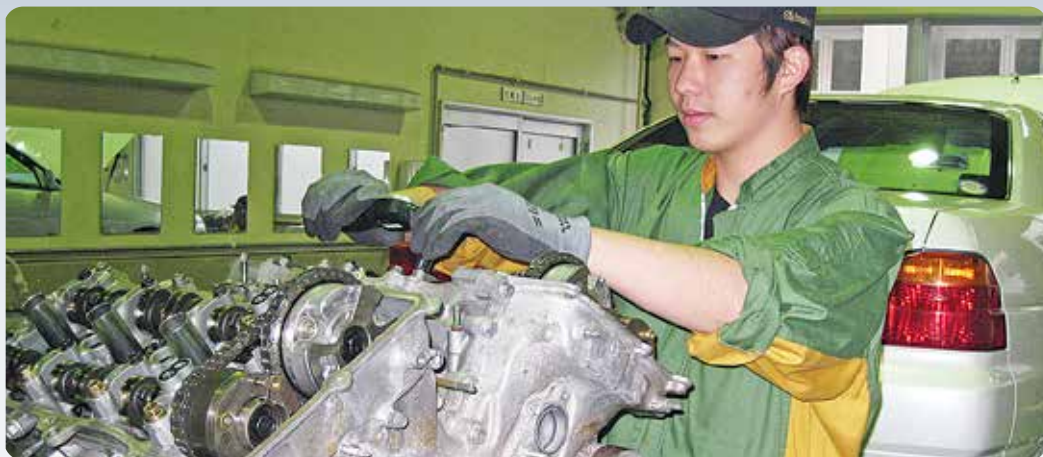
▲エンジン組立実習 エンジンの性能を左右する組立作業において、決められた順序や方法に従い、ボルト・ナットの締め付けを行っています。
