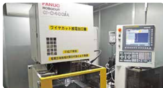
▲ワイヤカット放電加工機 ものづくりで原型（マスターモデル）となる金型の製造に欠かせない工作機械です。
